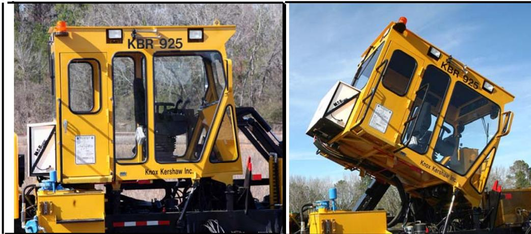
La Cabina se levanta o inclina para tener acceso directo a los componentes.
