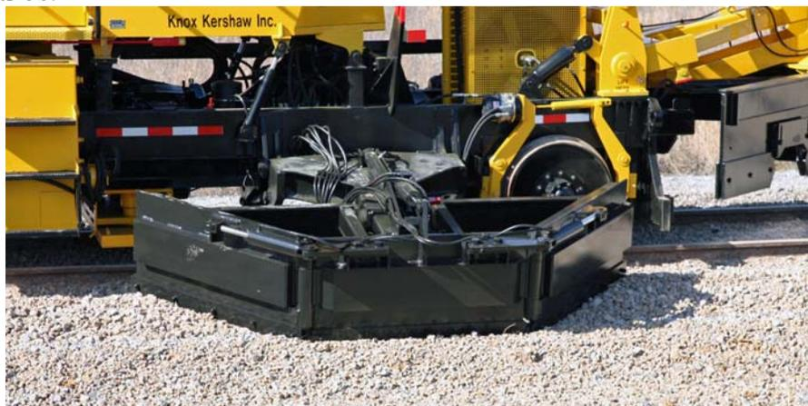
10. Cajas Deslizantes – Las cajas deslizantes de las alas, montadas horizontalmente, permiten al operador fácilmente cambiar la posición de las alas durante el regulado. Esta característica del diseño permite que la máquina sea más productiva. Las cajas deslizantes están diseñada de robustas placas que no requieren rodillos para mantenerlas alineadas.
