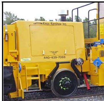
5. Tracción– La transmisión es modelo Funk de 6 velocidades con cambio en movimiento. Esto significa que no hay que parar la máquina para cambiar de velocidades, lo que resulta en una jornada más productiva. Esto también simplifica el sistema de propulsión hidrostática ya se puede utilizar un motor de volumen fijo en vez de un motor de volumen variable.
