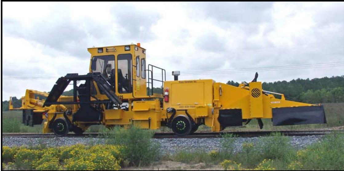
1. **Visibilidad** – La Reguladora de Balasto Modelo KBR 925 tiene una visibilidad inigualable. La máquina está diseñada para proporcionar una visibilidad total durante el trabajo y transito teniendo la mejor visibilidad en comparación con cualquier otra reguladora. El operador tiene una amplia visibilidad de las alas laterales y arado frontal. La cabina está diseñada para permitir una completa visibilidad de los componentes de trabajo.
