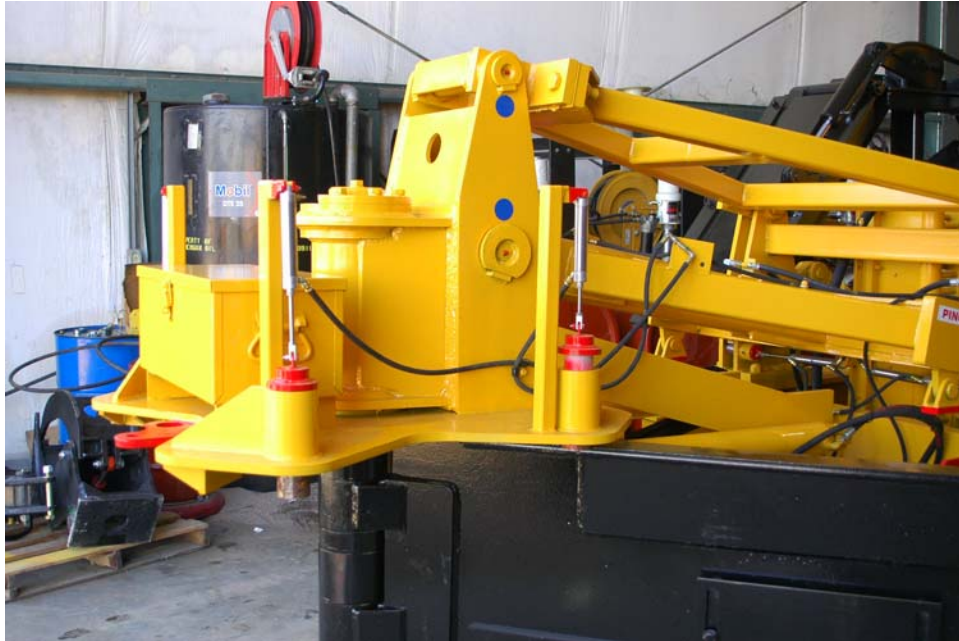
Vista lateral del mecanismo de seguro de las cuchillas.
